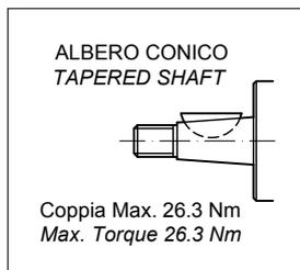
Bloccaggio giunto: n. 1 dado M7, coppia di serraggio 12 Nm.
