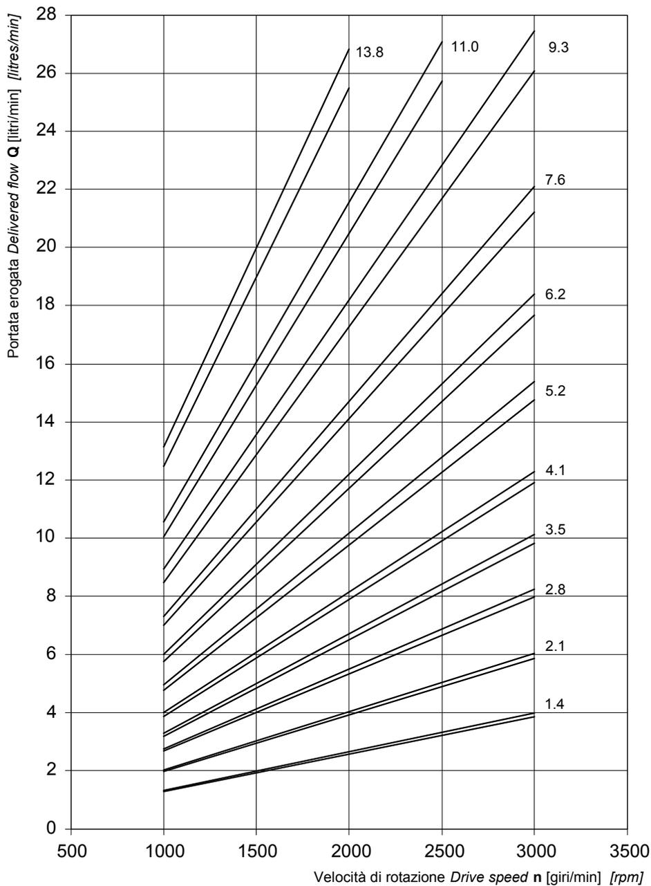
Le curve sono state ottenute alla temperatura di 50°C, utilizzando olio con viscosità 30 cSt alle pressioni sotto riportate.
