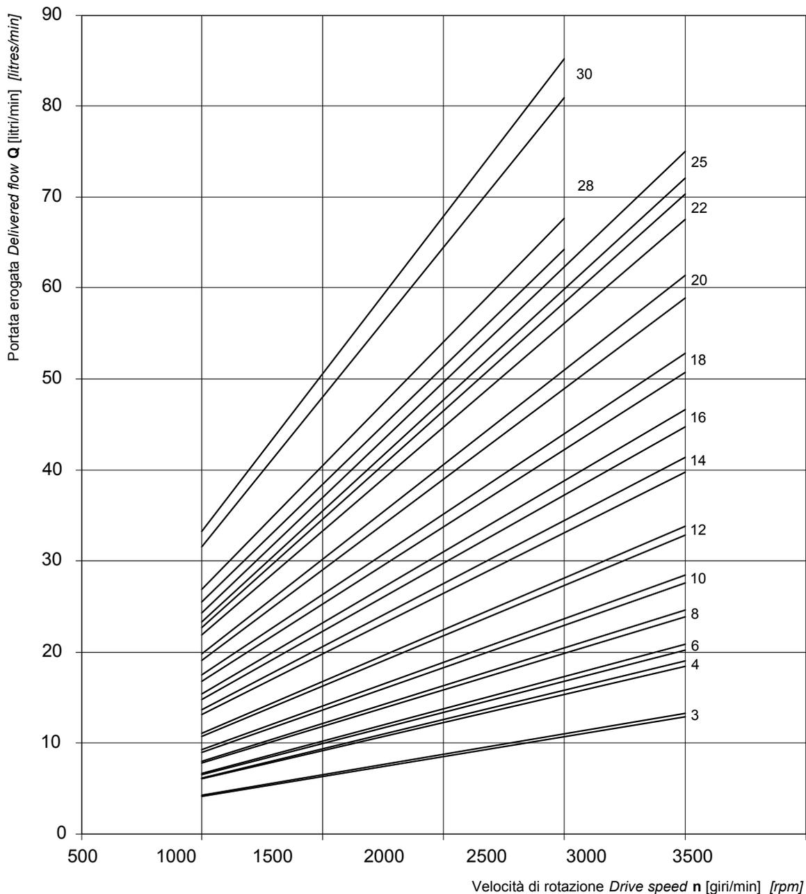
Le curve sono state ottenute alla temperatura di 50°C, utilizzando olio con viscosità 30 cSt alle pressioni sotto riportate.
