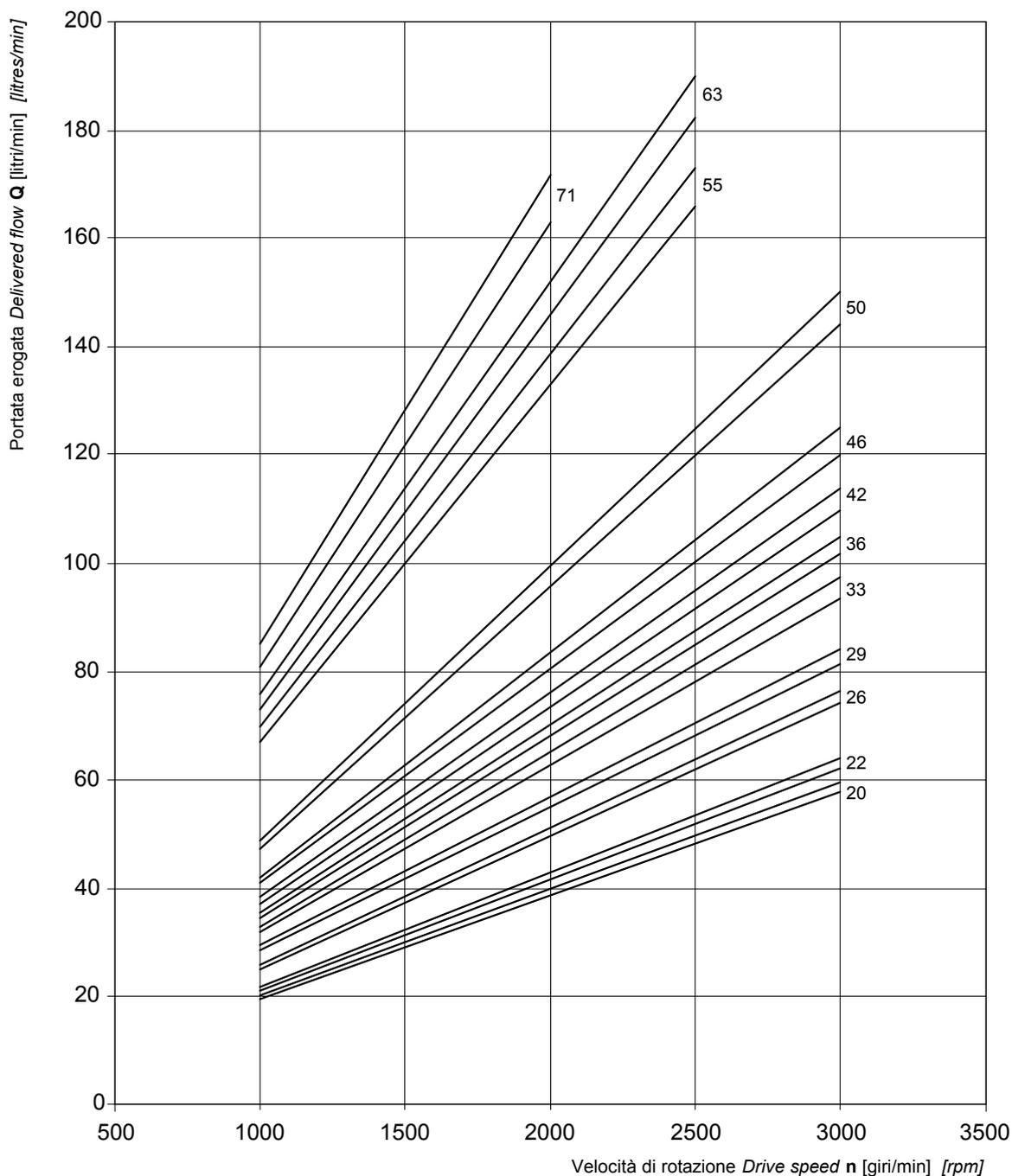
Le curve sono state ottenute alla temperatura di 50°C, utilizzando olio con viscosità 30 cSt alle pressioni sotto riportate.
