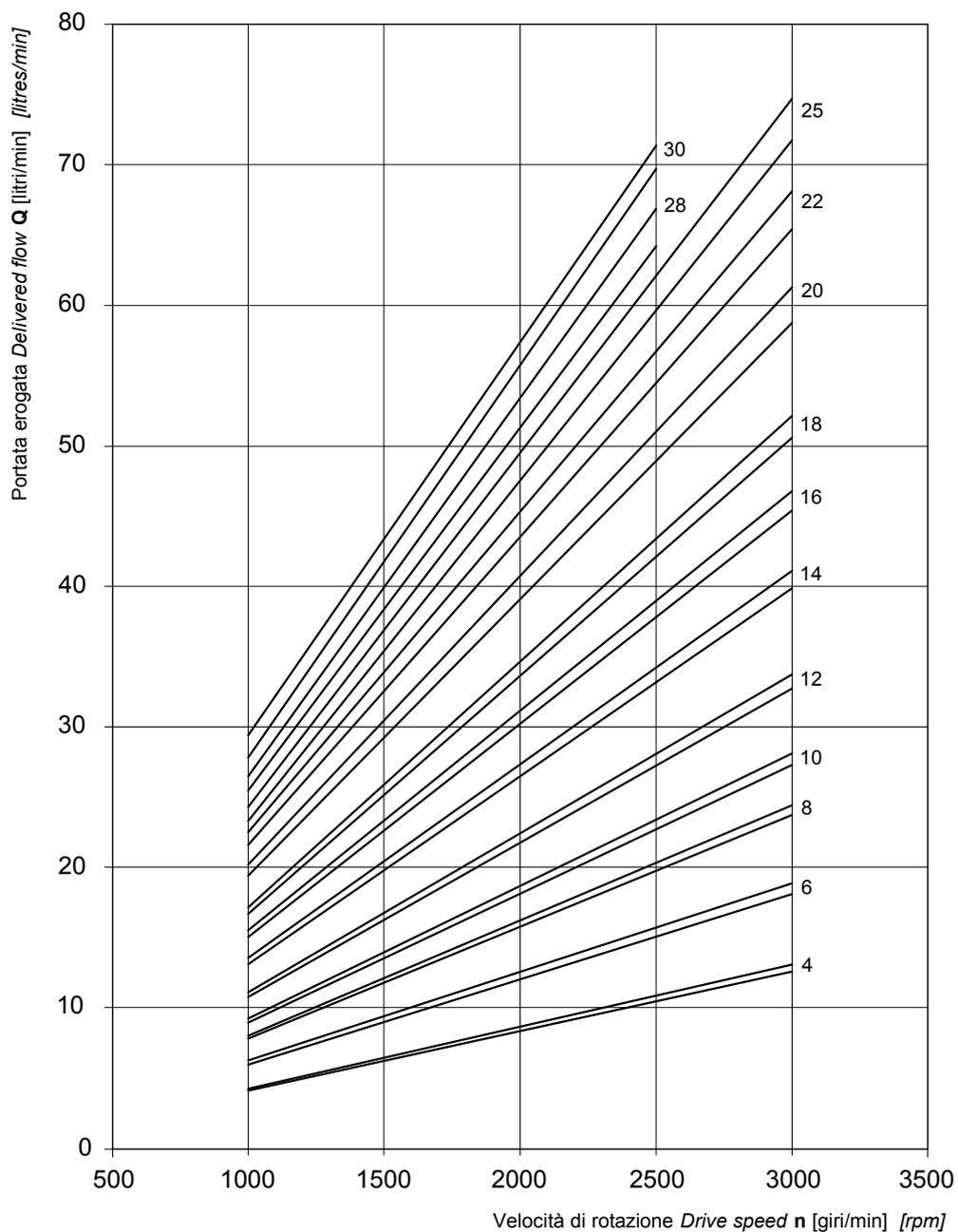
Le curve sono state ottenute alla temperatura di 50°C, utilizzando olio con viscosità 30 cSt alle pressioni sotto riportate.
