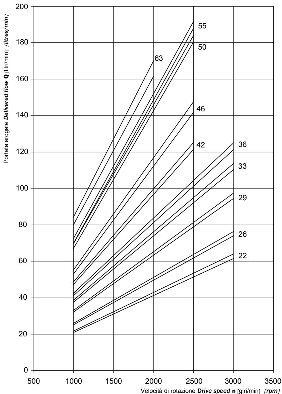
Le curve sono state ottenute alla temperatura di 50°C, utilizzando olio con viscosità 30 cSt alle pressioni sotto riportate.
